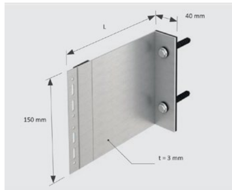
Abbildung 6: Festpunkt-Wandhalter mit Dübel.
