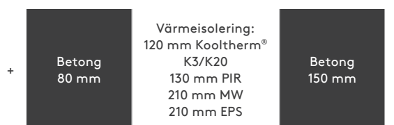
Bild 3. Genomsnitt av betongsandwichstrukturen. Källa /1/.
