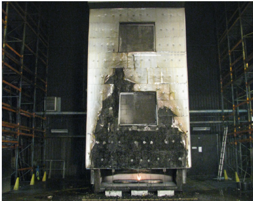
Figur 7. Fasad med Kooltherm® K15 C Skiva för ventilerad fasad utan beklädnad efter avslutat test.
